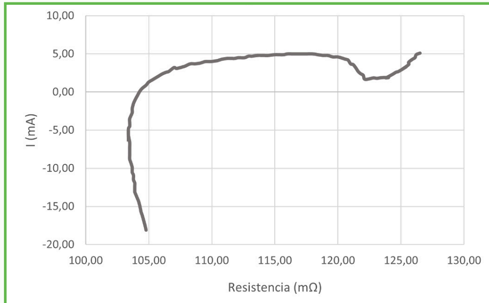
Figura 6. Diagrama de Nyquist para una batería que acaba de concluir su primera vida útil. Fuente: Universidad de Costa Rica.
