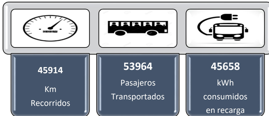
Figura 2. Totales de kilometraje, pasajeros y energía consumida por buses eléctricos en operación San José - Alajuela
