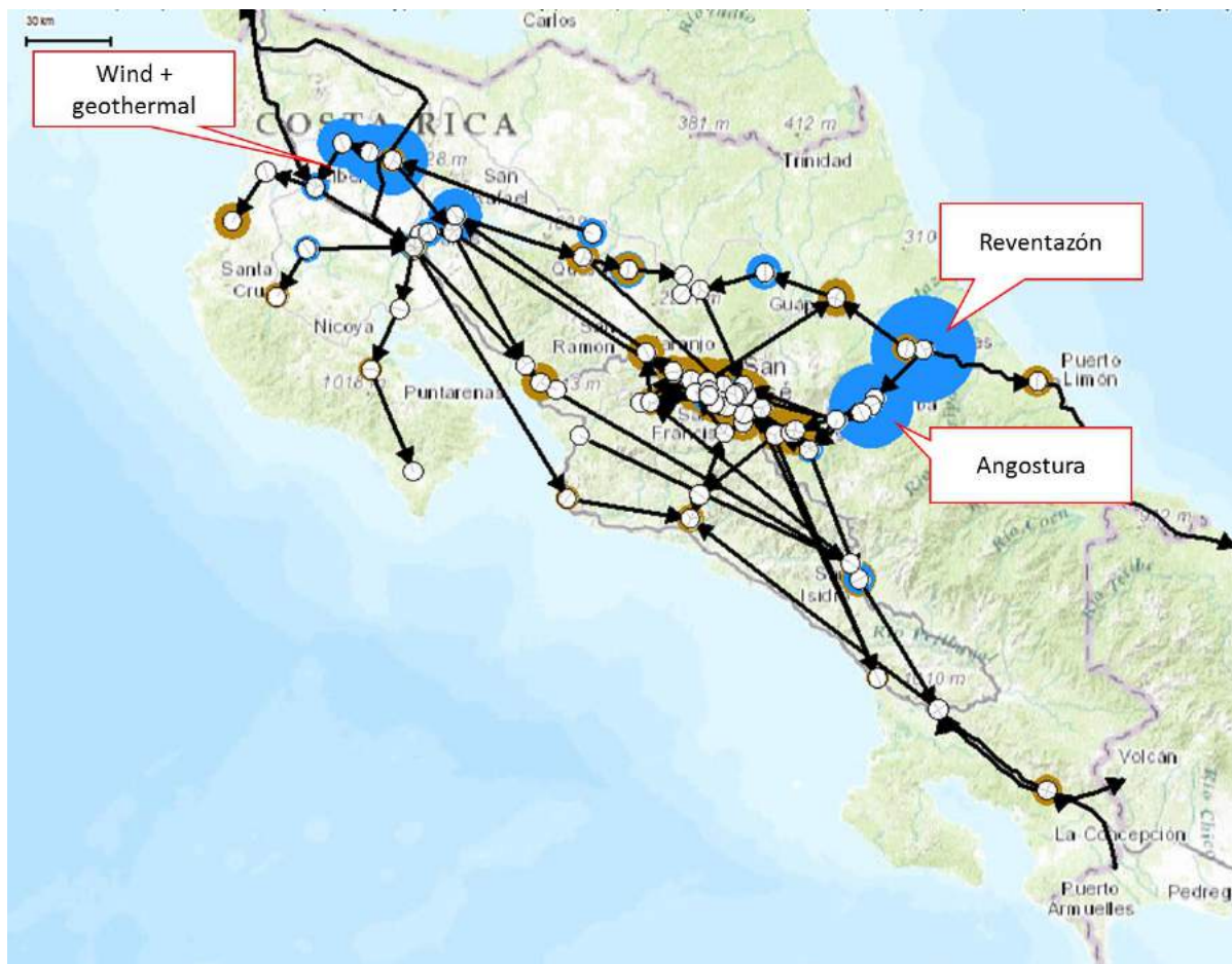
Figura 27: Generación alta durante la estación húmeda. La generación se marca en círculos azules, la carga en círculos marrones. Las direcciones de flujo de carga se marcan con flechas.
