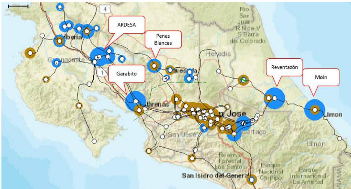
Figura 64: Distribución típica de la carga (marrón) y generación (azul) durante la carga máxima (atardecer temprano) en la estación seca, hidrología seca.
