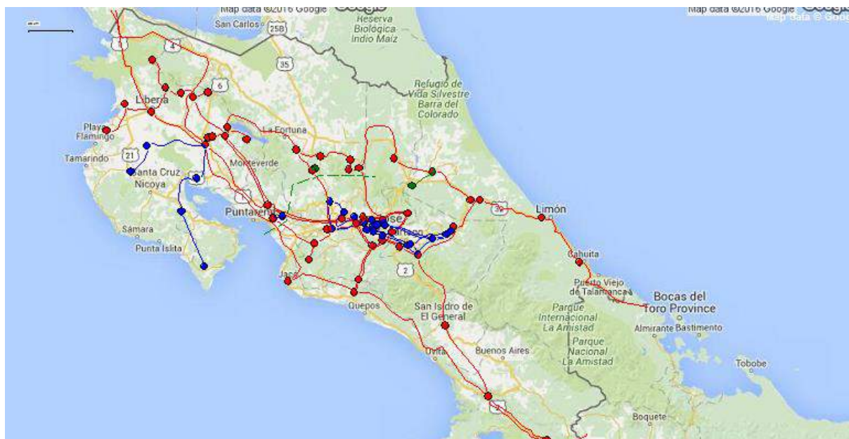
Figura 4: Diagrama geográfico de la red de Costa Rica. En rojo el sistema de transmisión en 230kV y en azul 138kV
