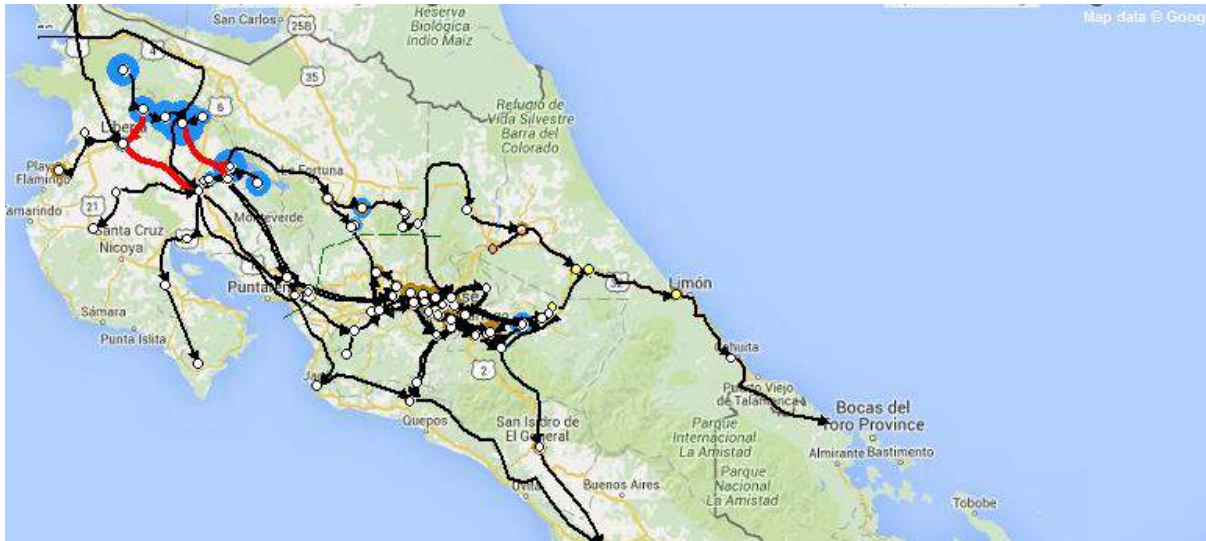
Figura 39: Enlaces con sobrecargas (en rojo) para el escenario DRY(H2002)-MINLOAD-ADV y con una transferencia regional de 100MW en sentido Norte-Sur.
